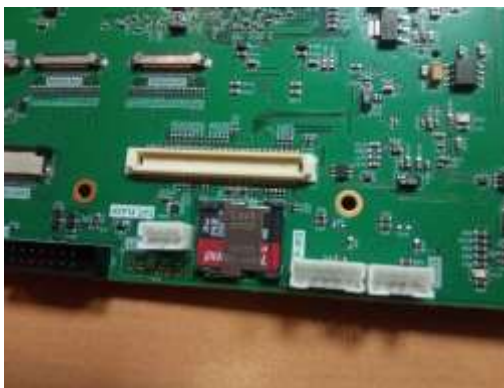
Рис. 3.5. установленная micro-SD карта в разъем-держатель
