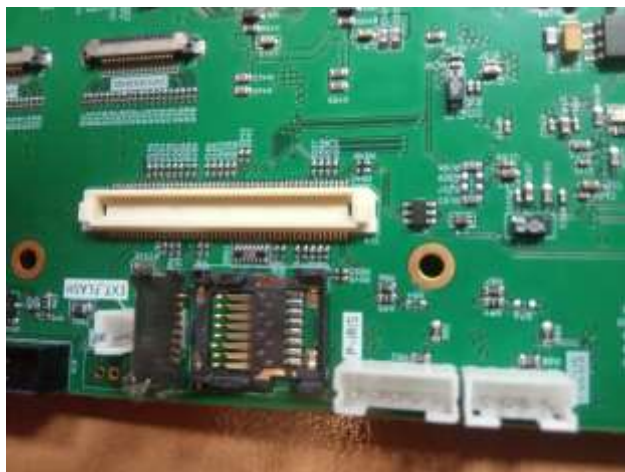
Рис. 3.3. открытый разъем-держатель micro-SD карты
