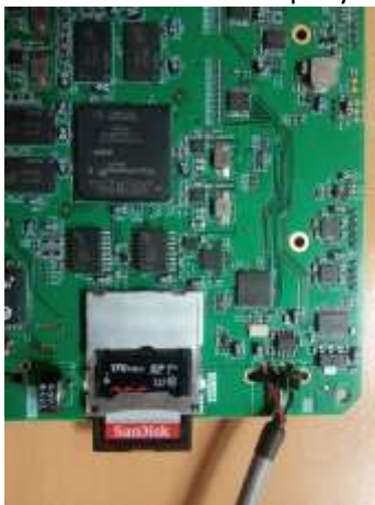
Рис. 2.1. установка SD карты в разъем держателя X17
