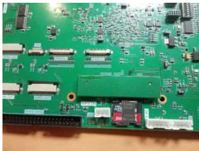
Рис. 4.3. установленная плата перемычка
