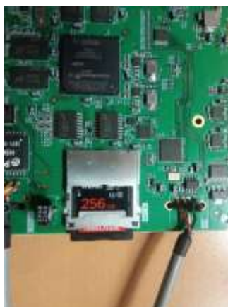
Рис. 2.2. установленная SD карта в разъем держателя X17
