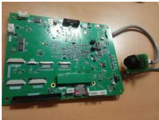
Рис. 6.2. Установленный Ethernet переходник
