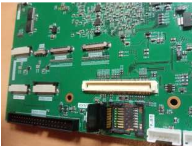
Рис. 3.4. процесс установки micro-SD карты в разъем-держатель
