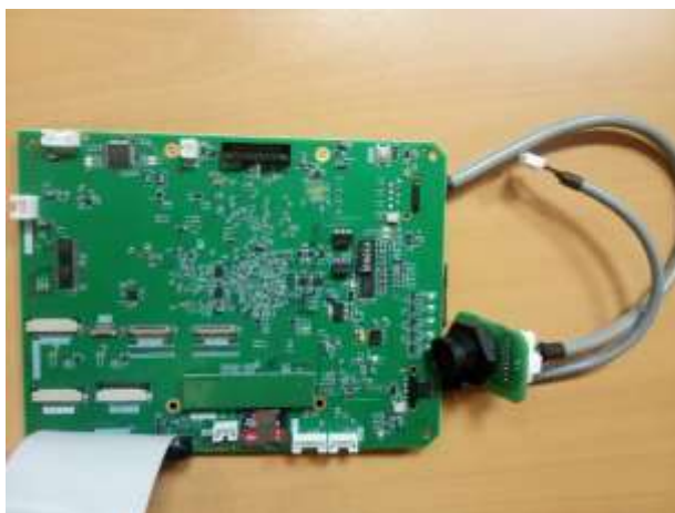
Рис. 6.4. Установленный «POWER BOARD» шлейф
