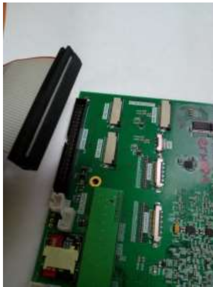
Рис. 6.3. Подключение «POWER BOARD» шлейфа
